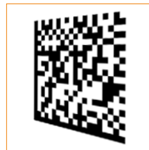
verzerrter Code durch Änderung des Blickwinkels
