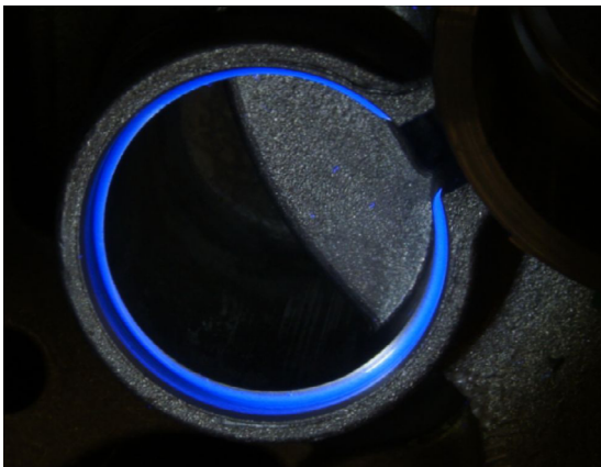
Gussteil mit fluoreszierendem Auftrag unter UV-Bestrahlung Links: Fluoreszenz für menschliches Auge gut zu erkennen
