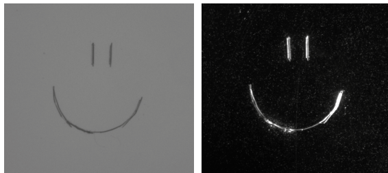
Kratzer auf Plexiglas - diffuses Durchlicht
