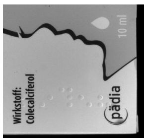
Klassische Bildaufnahme mithilfe einer LED-Dunkelfeldbeleuchtung
