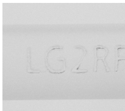
Transparente Stiftmine - diffuses Durchlicht
