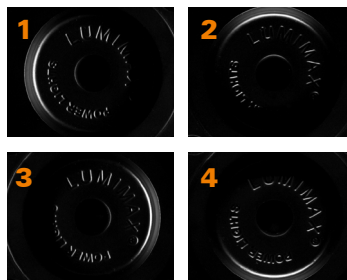
Shape-from-Shading Bildaufnahme mithilfe von 4 Miniaturbalken der LSB-Serie
